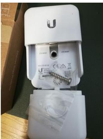
Abbiamo inoltre pensato di inserire un apposito scaricatore (sempre Ubiquity) per proteggere l'AP dalle sovratensioni durante i temporali.
